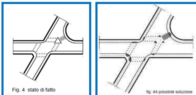
Fig. 5 Incroci fra strade non ortogonali con marciapiedi larghi (con o senza canalizzazione per la svolta a destra).
