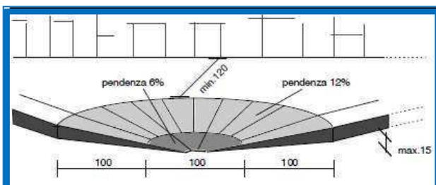
Scivolo a settori circolari composto da settori con Apertura angolare di 15°, raggio esterno di cm.150 e Raggio interno di cm. 50. La pendenza del 12% consente il raccordo fra dislivelli che non superano i cm. 15 di altezza. La combinazione degli elementi centrali e l'eliminazione di uno o più elementi della corona può consentire la posa del manufatto oltre che in rettilineo anche lungo le curve di diverso raggio.
