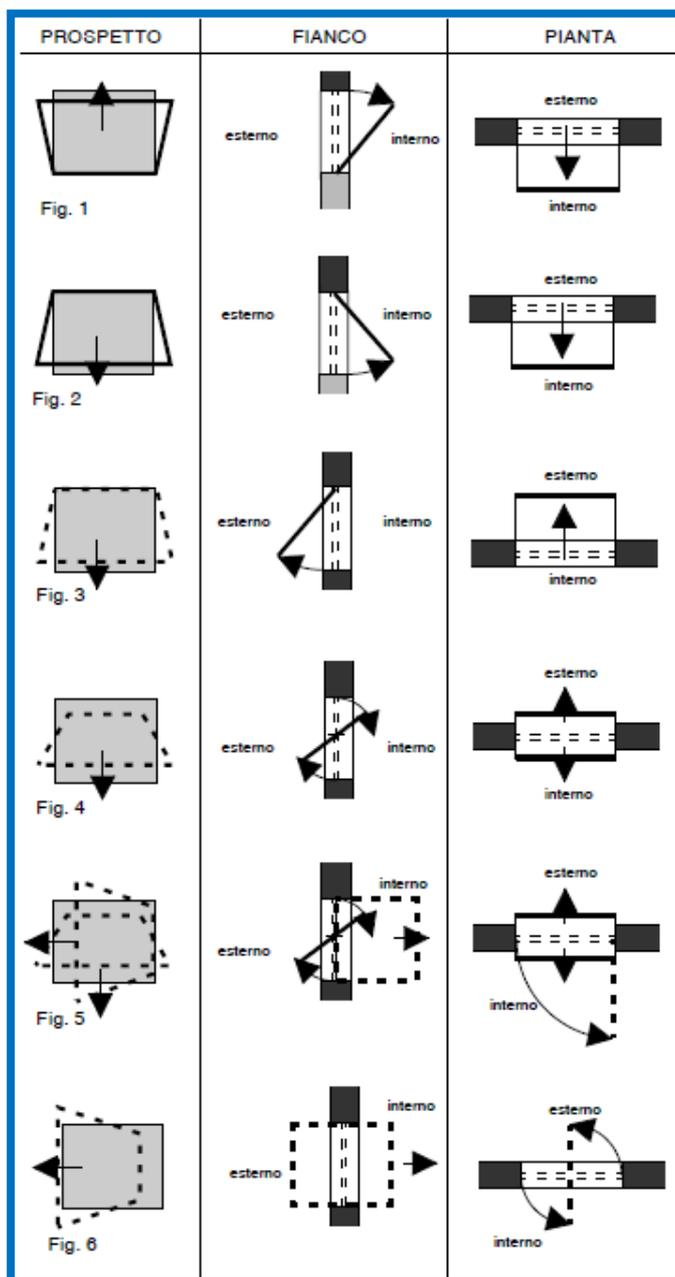
I serramenti, in cui si utilizza l'apertura e la chiusura dell'anta a scorrimento orizzontale possono essere facilmente manovrate da tutte le persone purché il movimento non richieda una forza superiore ad 8 Kg. e la maniglia sia situata ad un'altezza adeguata alle persone in carrozzina. In genere questi infissi richiedono una adeguata manutenzione.
