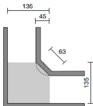
L'esempio grafico illustra i minimi dimensionali nella rotazione a 90° di una carrozzina con corridoio di larghezza cm. 90 e spigolo interno inclinato a 45°.
