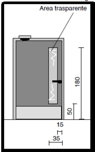
Il sistema di apertura o di chiusura di un battente della porta non dovrebbe richiedere una forza di pressione superiore a Kg.8, meglio se i valori sono (soprattutto per le porte interne) compresi fra i Kg.1 e Kg.3,5.
