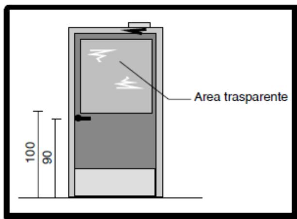
In caso di porte automatizzate, occorre porre molta attenzione alla collocazione delle fotocellule di rilevamento eventualmente in dotazione.
