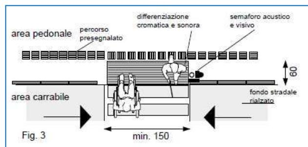
Quando la carreggiata è a basso traffico veicolare si può ipotizzare anche un rialzo della stessa in prossimità dell'attraversamento con una rugosità accentuata che, posta trasversalmente al senso di marcia induce il conducente del veicolo a procedere con una maggiore attenzione.
