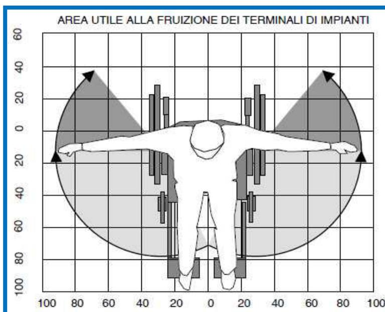
Molto spesso, quando in fase progettuale si predispongono l'impiantistica di un edificio, si trascurano alcuni particolari molto importanti come l'accesso ai comandi dei radiatori termici.
