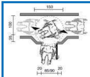
L'utilizzazione degli angoli inclinati consentono, purché il percorso non sia di larghezza inferiore a cm. 100 una migliore manovra di accostamento alla porta ed una rotazione, in più tempi, della carrozzina con la conseguente inversione di marcia.
