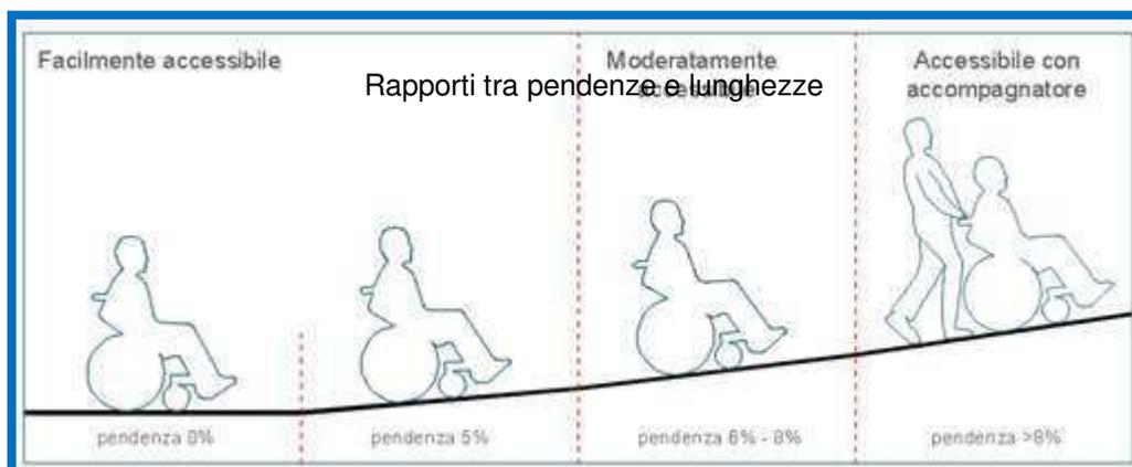
Superare un dislivello con il solo ausilio di rampe inclinate rappresenta un grosso errore progettuale, infatti, dal punto di vista antinfortunistico il piano inclinato, di cruciale importanza per quelle persone che utilizzano sedie a ruote o spingono passeggini diventa estremamente pericoloso per tutte le altre persone.
