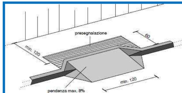
Scivolo rettilineo con rampa a piano inclinato composto in parte da un grigliato o caditoia. La possibile soluzione può essere adottata per superare la forte contropendenza della strada funzionalmente al deflusso dell'acqua piovana.
