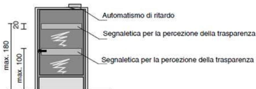
La larghezza minima di un'anta per il passaggio di una carrozzina prevista dal D.P.R. 384 e dal D.M. 236 corrisponde già a quanto prodotto industrialmente se si considera che il modulo di base è cm.10 e corrisponde alla distanza fra i due settori verticali del controtelaio.
