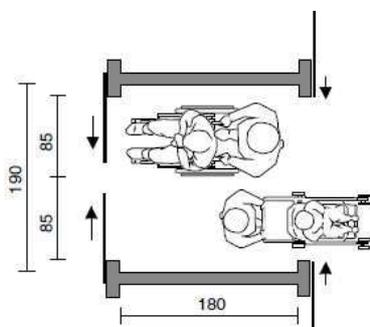
L'esempio illustra come, in presenza di porte a scorrimento laterale, si possa ridurre lo spazio a cm. 180. Il battente o i battenti non dovranno avere una larghezza inferiore a cm. 85 e, qualora siano previste con una certa frequenza situazioni coincidenti di passaggio in senso alternato è necessario prevedere una larghezza del corridoio di almeno cm. 190.
