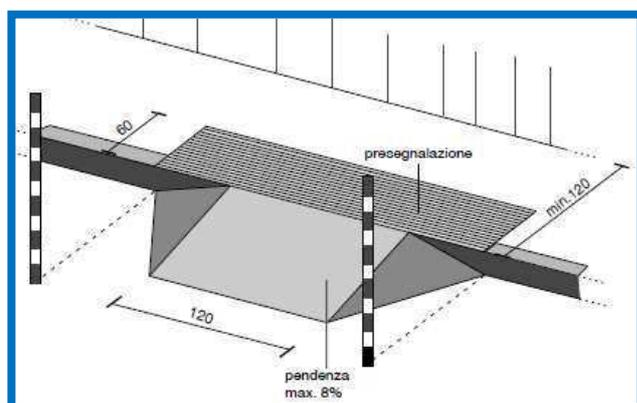
Scivolo rettilineo con rampa a piano inclinato esterna al percorso. I raccordi esterni vengono usati in presenza di percorsi pedonali di larghezza limitata e quando la sporgenza verso l'area carrabile è delimitata da parcheggio. I paletti impediscono l'occupazione della rampa da parte di veicoli.
