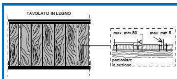
Sono sconsigliati trattamenti della superficie posti diagonalmente al senso di marcia induce le ruote piroettanti della carrozzina ad una deviazione dal percorso, oppure destabilizza una persona con le grucce o arti meccanici. V. Figura sottostante:
