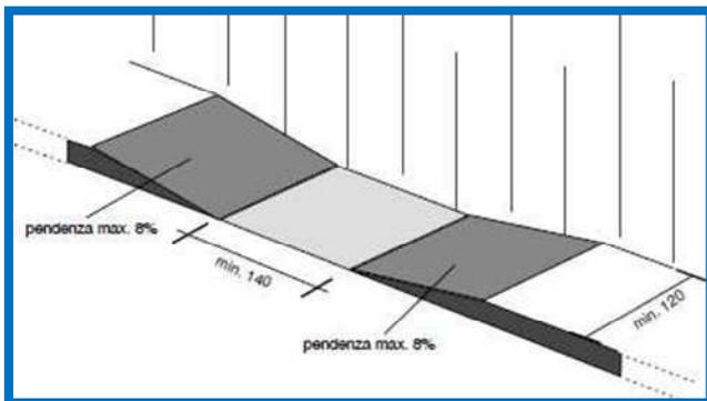
Scivolo rettilineo con doppia rampa a piano inclinato. L'adozione della doppia rampa collocata nel senso longitudinale rispetto alla direzione del percorso permette di raccordare l'area pedonale con il passo carrabile che la interseca, oppure consente l'utilizzo di un attraversamento pedonale qualora il dislivello eccessivo fra l'area pedonale e l'area carrabile non consentano alle rampe di raggiungere pendenze a norma.
