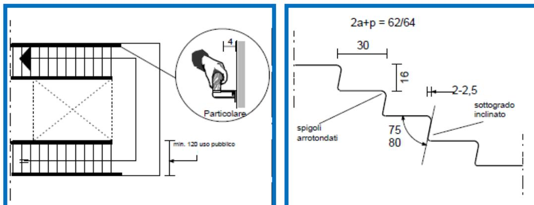
Scale. Presenza di corrimano doppio, ad altezza 100 e 75 cm., che prosegue per 30 cm. Oltre i gradini all'estremità; parapetto altezza 100 cm. da piano di calpestio, costituito da elementi non attraversabili da oggetto di 10 cm.
