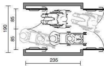
La distanza fra le porte poste in successione e con lo stesso senso di apertura dovrà essere conseguente all'ingombro di apertura dell'anta aumentato di uno spazio minimo di cm.150 così da consentire un'agile manovra della persona in carrozzina anche quando, soprattutto in ambienti pubblici, avviene il passaggio di più persone.
