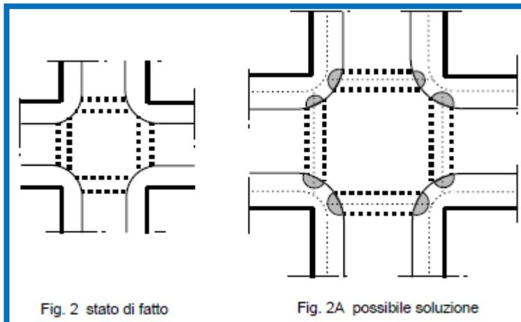
Fig. 3 Incroci ortogonali con svolte a destra canalizzate.
